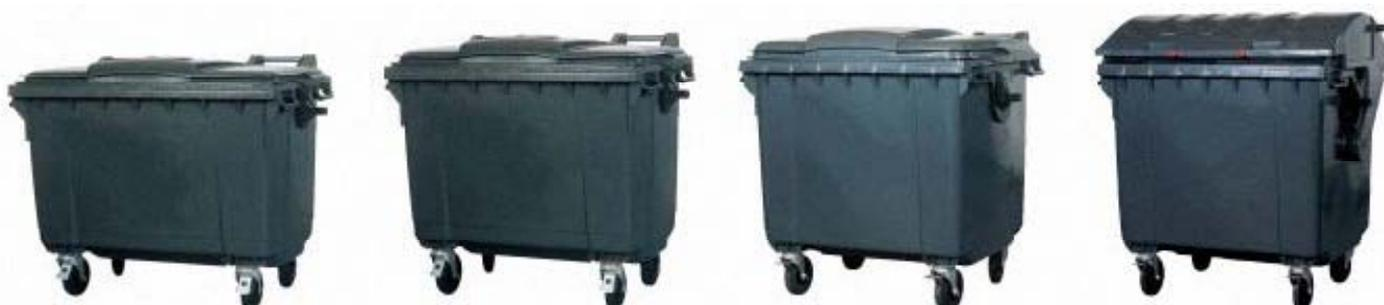
Contenedores de polietileno inyectado de alta densidad, coloreado en masa y con protección contra los rayos ultravioletas. Cumplen con las normas EN 840 y revisión 2004. Modelo de 1.100 litros con tapa recta o curva. Colores estándar gris, verde, azul, amarillo y marrón; otros colores según demanda.
